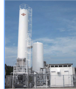
PSAシリーズの深冷空気分離装置は、高純度の窒素と酸素を供給可能
